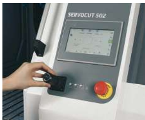
ジョイスティックで簡単操作モモモモオペレーターの安全を守る両手操作
