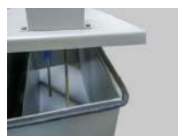
循環タンクレベルセンサ
