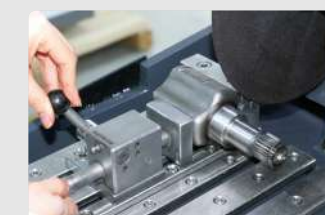
ワンタッチクランプはレバーを倒すだけ
