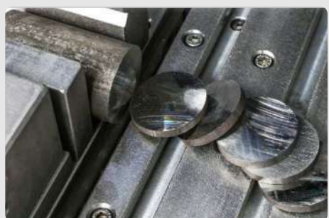
X軸を使用した平行スライス切断
