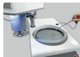
給水バルブは取外して清掃にもご使用出来ます。
