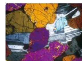
専用ホルダーで20μmの薄片試料を作成
