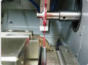
レーザーで切断ラインを確認
