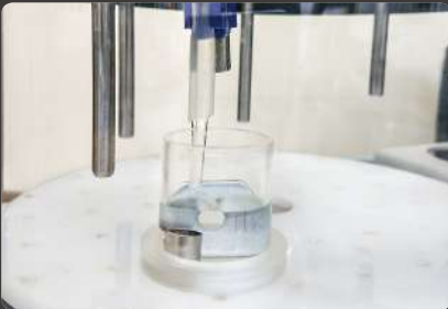
チャンバー内を減圧させて樹脂を投入
