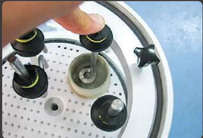
軽い試料の浮上りを防止する押さえ棒
